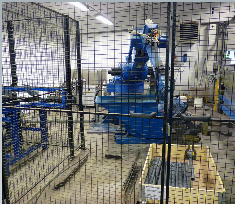
En helautomatisk cell för robotskärning – med vatten!
